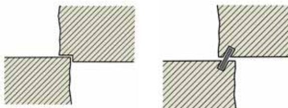
Fig 7.19 Låsning mellan blocksteg kan uppnås med urtag eller rostfria dubbar.
