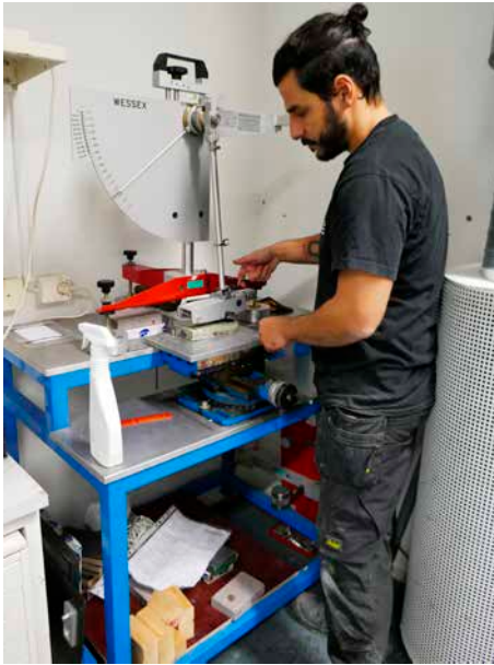
▲ Pendelmetoden, där friktionen mäts med en pendlande gummiklack.
