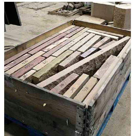
Färdiga, uppmärkta murstenar i olika storlekar.
