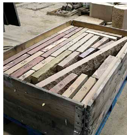
Färdiga, uppmärkta murstenar i olika storlekar.
