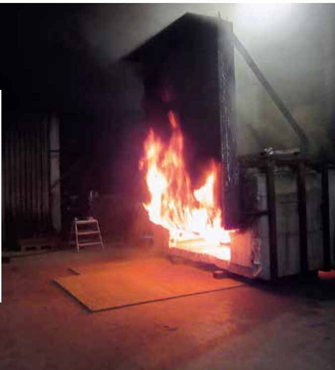
Fyra mätpunkter under fasadens ytskikt mätte brandutvecklingen.
