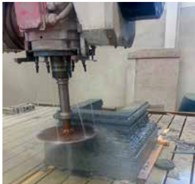
Vår moderna 6-axliga CNC-utrustning formar avancerade stendetaljer.
