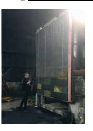
Fyra mätpunkter under fasadens ytskikt mätte brandutvecklingen.
