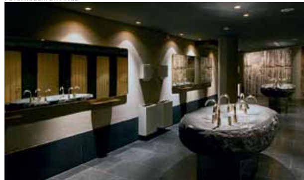
Toalettgolv av finslipad Nero Assoluto Z. Stora homogena handfat i samma material med polerad översida och råkilade sidor. I bakgrunden syns undre delen av berget som sticker upp i restaurangen. Berget är borrat med tät söm.
