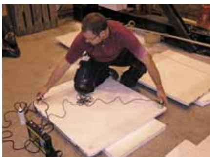
Mätning av ultraljudshastighet i laboratorium
