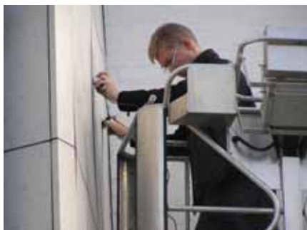
Mätning av ultraljudshastighet på fasaden
