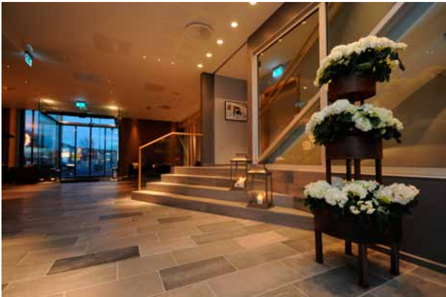
Det er inngang til resepsjonen fra to sider. Alle gulv og trapper er belagt med antikkbørstet flis i Oppdalskifer.
