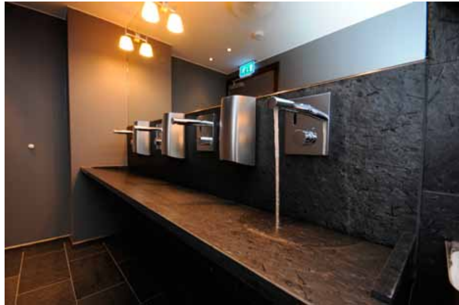
På toalettene er det lagt slipt flis i Ottaskifer på gulvene og i vaskerennene er det slipt Ottaskifer.
