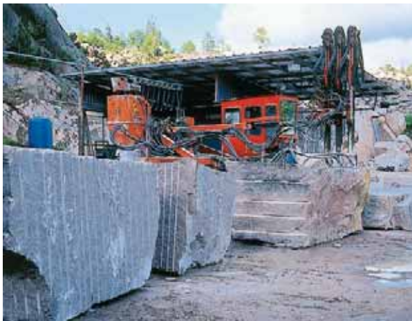
På huggplanen kilas ämnena ner till rätvinkliga block.
