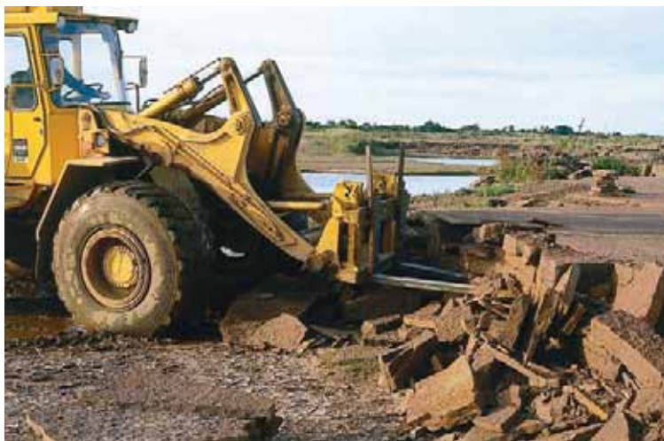
Tunna kalkstensbankar i bergets ytskikt kilas direkt ur brottet med hjälp av lastmaskin med gafflar. För hand kilar man sedan ut plattor för mark-beläggningar.
