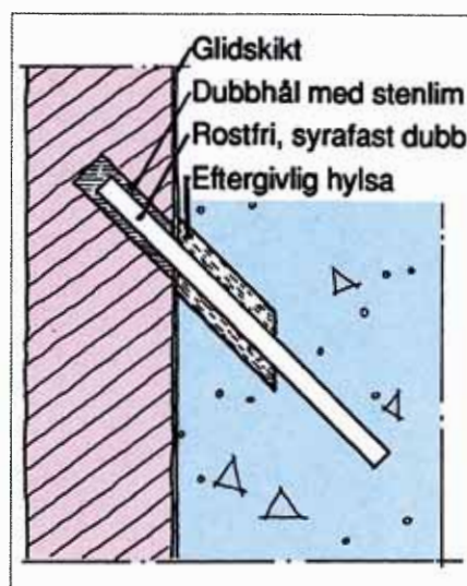
58. Dubbinfästning av platta i betongelement. Eftergivlig hylsa på dubben och folie mot betongen medger rörelser.
