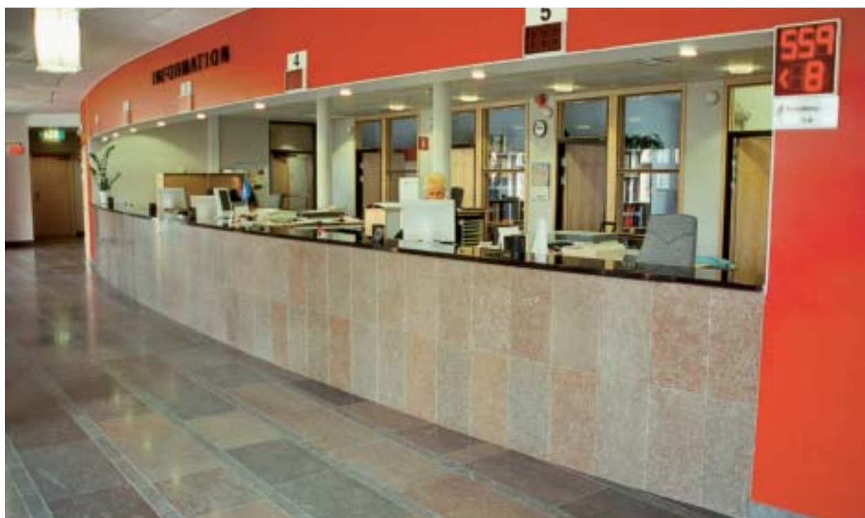
Fig 6.19 Reception med golv och diskfront i finslipad kalksten. Bänkskiva av polerad diabas.
