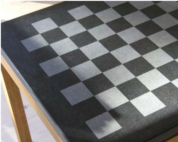
Elegant schackbräde som bordsskiva för utemiljön. Den svarta diabas ger god kontrast mellan den slipade och den blästrade ytan.
