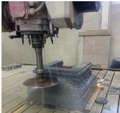
Vår moderna 6-axliga CNC-utrustning formar avancerade stendetaljer.
