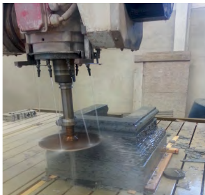
Vår moderna 6-axliga CNC-utrustning formar avancerade stendetaljer.
